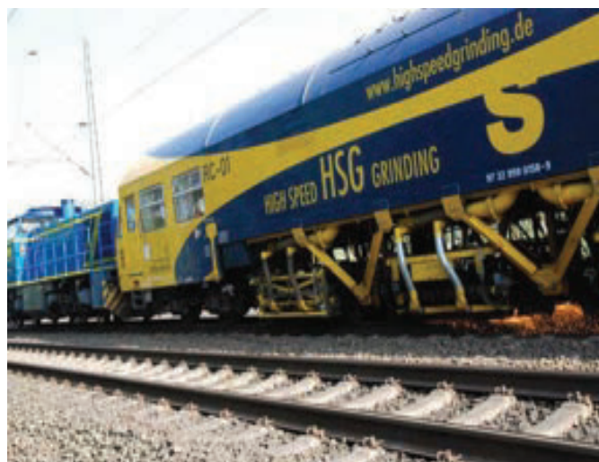
Bild 30: Schleifzug HSG
